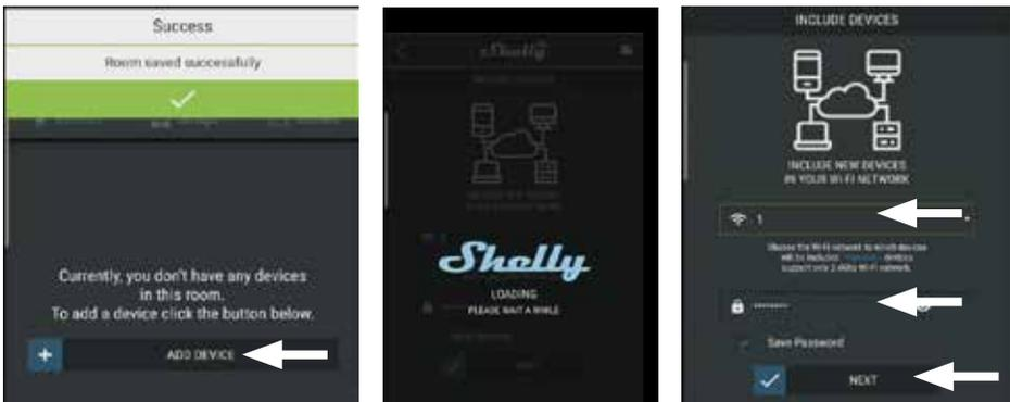
Folgen Sie den Anweisungen am Gerät (Zugriff Standort freigeben, Auswahl W-LAN, Eingabe Passwort, ...). Die Geräte (Smartphone und Fernstart-System) müssen sich im selben Netzwerk befinden.
