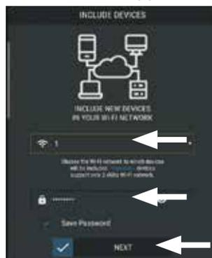
Suivez les instructions sur l'appareil (validation de l'accès au site, sélection de W-LAN, saisie du mot de passe, ...). Les appareils (téléphone mobile et système de mise en marche à distance) doivent se trouver dans le même réseau.
