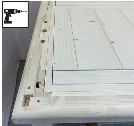
Bohrer 3 mm, 10 Stk. Schrauben 3 x 40 mm
