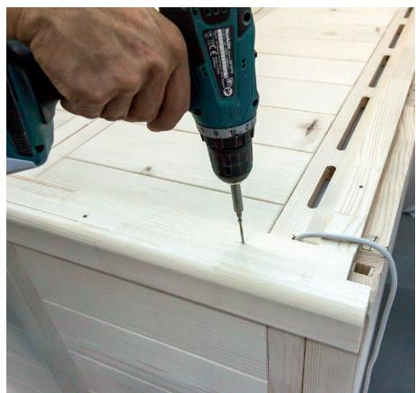
Bohrer 3 mm, 14 Stk. Schrauben 3 x 40 mm
