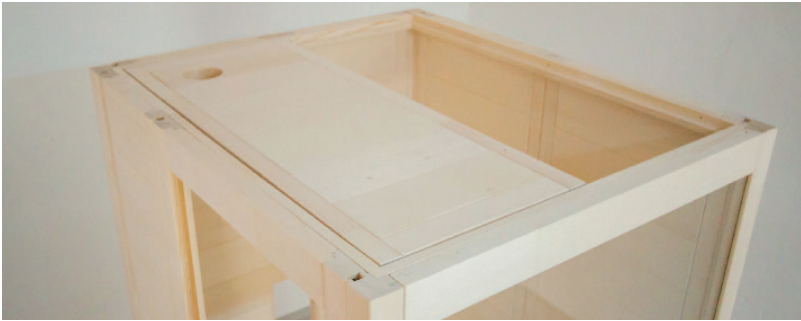
Afb. 14: Plaatsen van dakelementen voorzijde
