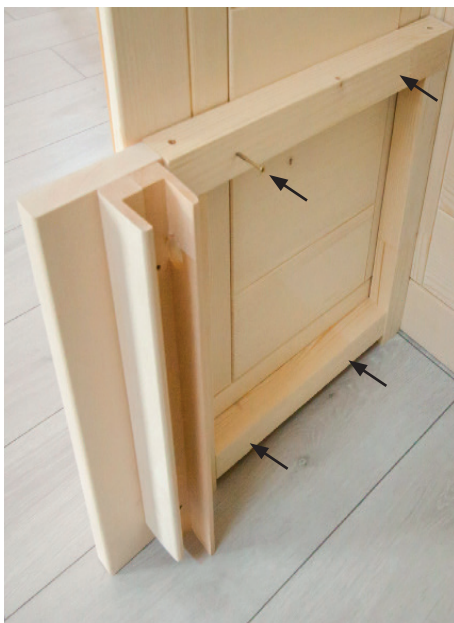
Fig. 18: Montar os apoios do banco
