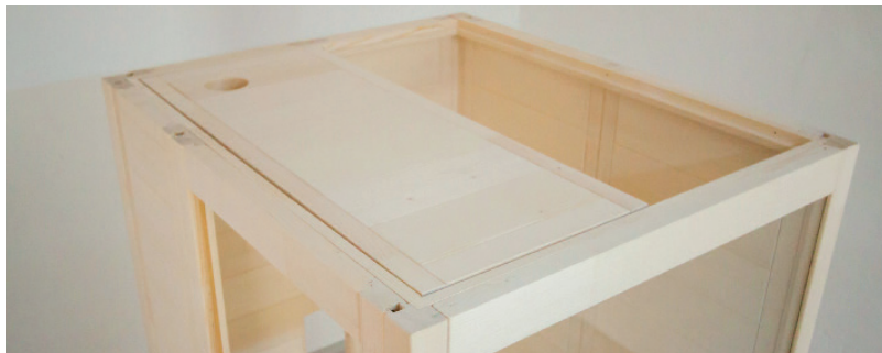
Fig. 14 : Insertion de l'élément de toit avant
