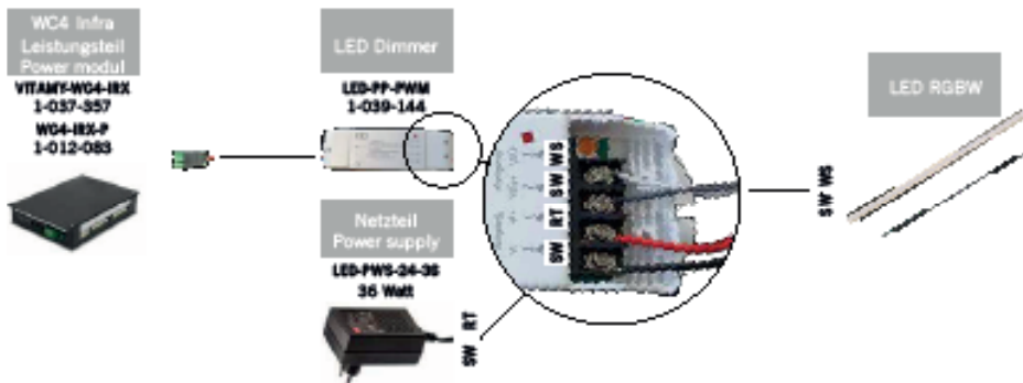
Fig. 28: Conexão da tira LED ao comando
