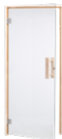
Porta sauna DS40, vetro trasparente Telaio a 3 lati, 8 mm ESG, cerniere fissabili a sinistra o a destra Vetro: 824 x 1997 mm Telaio in abete: 920 x 2060 x 80 mm Cod. art. DS80-3CS-824 (824 mm)
