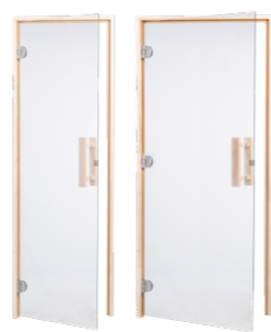
DS40 szaunaajtó 3 oldalú keret, átlátszó üveg, 8 mm-es ESG, a pántok bal és jobb oldalon is elhelyezhetők Üveg: 590 vagy 680 x 1915 mm Fenyő keret: 650 vagy 740 x 1960 x 40 mm Cikksz. DS40-3CS-590 (590 mm) Cikksz. DS40-3CS-680 (680 mm)
